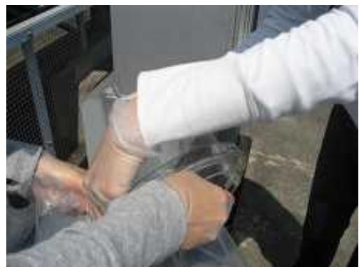
11. 大気採取用フィルター ボルダーを回収し、指定のチャック付ポリ袋に入れて、機材収納箱に収納する。
