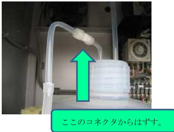
7. ロートとテフロンチューブのジョイントのネジをゆるめ、テフロンチューブをジョイントとともに5Lテフロン瓶内に押し込む。その後、アルミジャケットごとサンプラーの外に出す。
