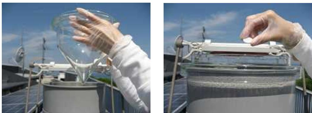
15. 5L テフロン瓶をチャック付ポリ袋から取り出し、アルミジャケットに入れ。その後、テフロンチューブをチャック付ポリ袋から取り出し、5L テフロン瓶に取り付ける。5L テフロン瓶の入ったアルミジャケットを冷却器の上に置く。
