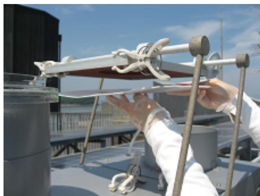
19. 大気採取用フィルター ボルダーにアルミホイルを巻き、サンプラーの所定の位置に設置する。
