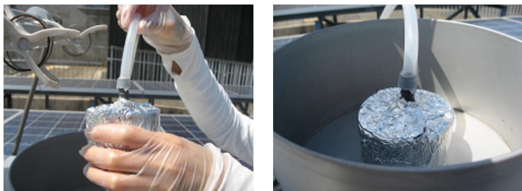
20. 降水サンプラーの感雨計を約 200 ml の超純水で洗浄する。
