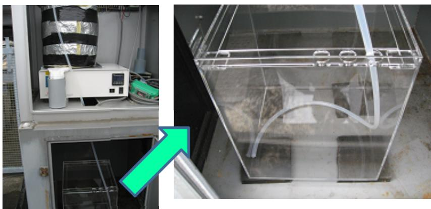
3. 冷却器の電源を OFF にした後、感雨センサーを素手で触り、ロート部の蓋がサンプラーの中央に来たところで、サンプラー内部にある主電源を OFF にする。(小松製作所製サンプラーの場合は、洗浄スイッチを ON にする。)
