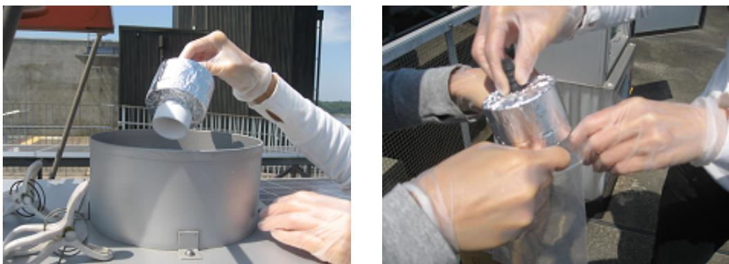
12. キムタオルに水を湿らせてサンプラーの内側及び外側、冷却器のプレート表面などを拭いて掃除する。
