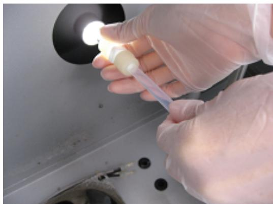
8. 5Lテフロン瓶からテフロンチューブを取りはずし、テフロンチューブをチャック付ポリ袋に入れて、機材収納箱に収納する。
