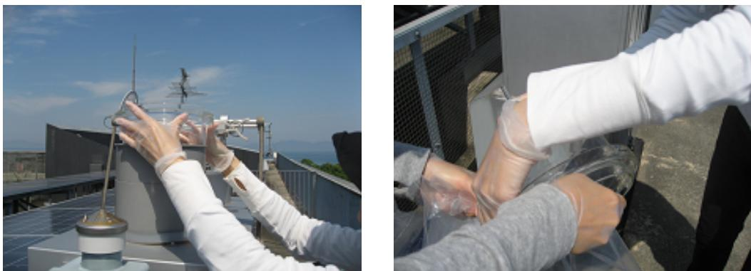
11. 大気採取用フィルターボルダーを回収し、指定のチャック付ポリ袋に入れて、機材収納箱に収納する。
