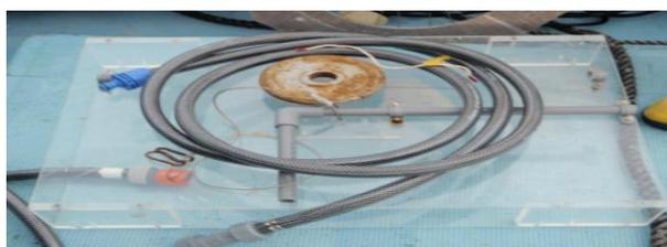
図-2 直上水採取装置
