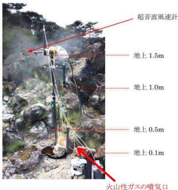
図2 噴気地帯における気中水銀の観測風景
