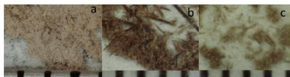
図 3 粉碎毛髪. a)ローラーボールミル、b)スピードミル、c) ロールプレス・ターボミル、目盛=1mm
