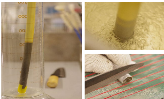
写真-1 底質の分級、凍結、カッティング作業
