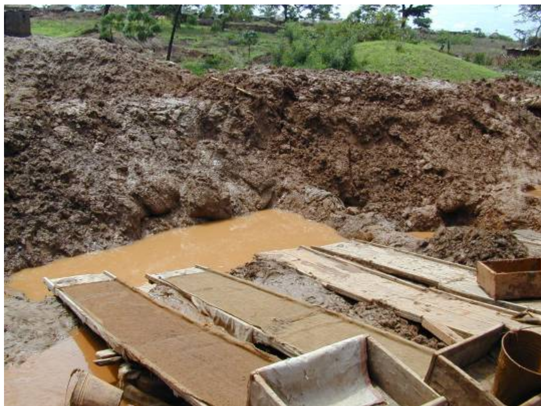
図6 重力分離による鉱石の選択
