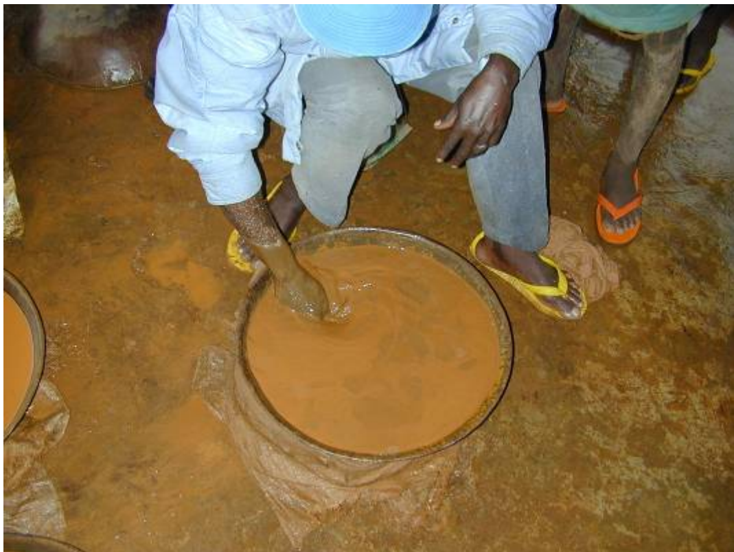
図8 金鉱石と水銀の混合
