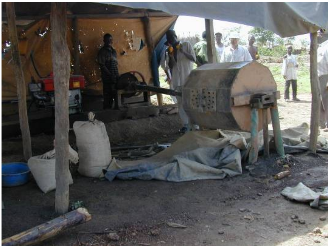
図5 ボールミルによる鉱石の粉碎
