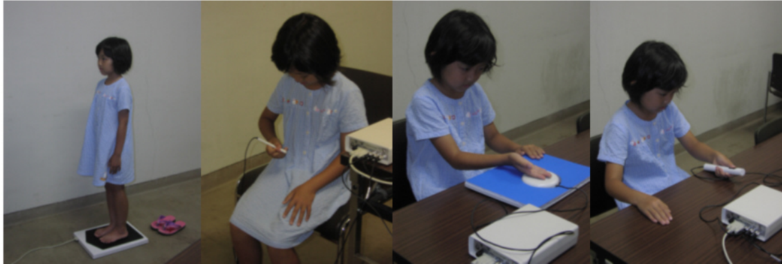
図 CATSYS システムで測定できる身体重心動揺、ふるえ、耳-手協調運動、反応時間の測定光景
