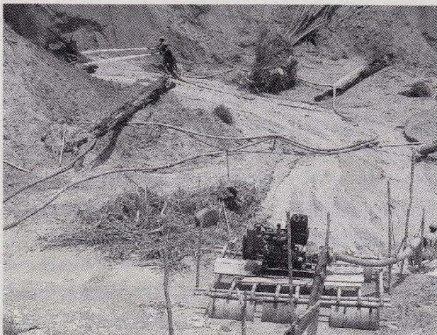
金採掘の様子（多量の水をかけて泥と一緒に金を吸い上げる）
