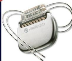
回路と電池を内蔵しており、電池が消耗すれば、刺激装置を交換します。目安は2年～5年程度です。
