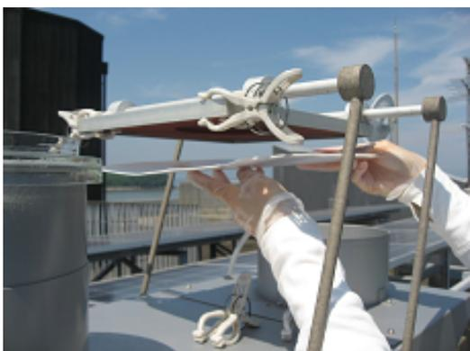
19. 大気採取用フィルターホルダーにアルミホイルを巻き、サンプラーの所定の位置に設置する。
