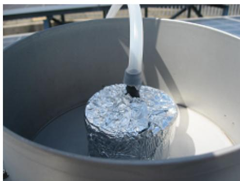
20. 降水サンプラーの感雨計を約 200 ml の超純水で洗浄する。
