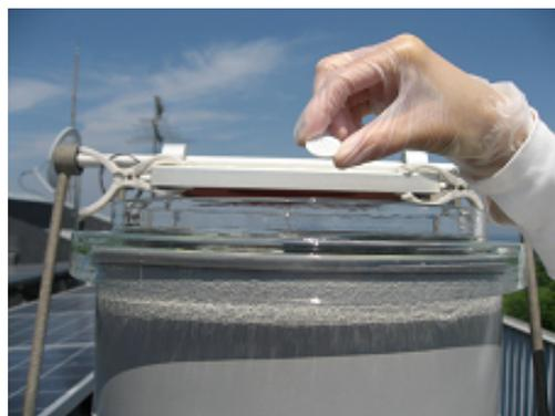
15. 5L テフロン瓶をチャック付ポリ袋から取り出し、アルミジャケットに入れる。その後、テフロンチューブをチャック付ポリ袋から取り出し、5L テフロン瓶に取り付ける。5L テフロン瓶の入ったアルミジャケットを冷却器の上に置く。
