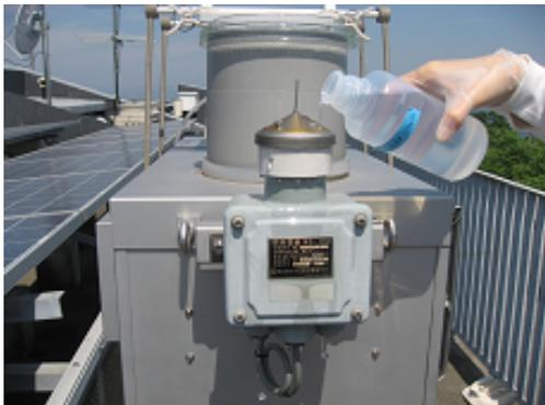
21. すべての機材の取り付けを確認した後、降水サンプラーの主電源を ON にし、冷却器の電源も ON にする。（小松製作所製サンプラーの場合は、洗浄スイッチを OFF にする。）その後、降水サンプラーの扉を閉める。
