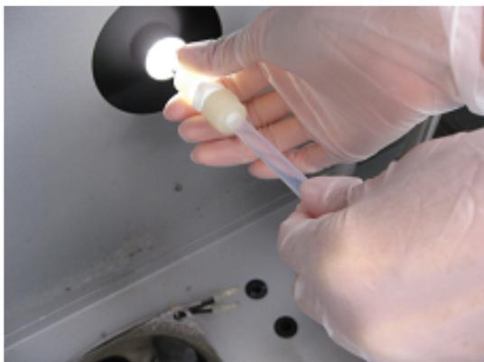
8. 5Lテフロン瓶からテフロンチューブをとりはずし、テフロンチューブをチャック付ポリ袋に入れて、機材収納箱に収納する。
