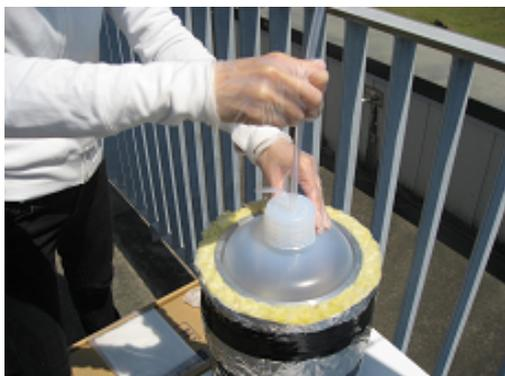
16. ジョイント付テフロンチューブをロートに接続する。
