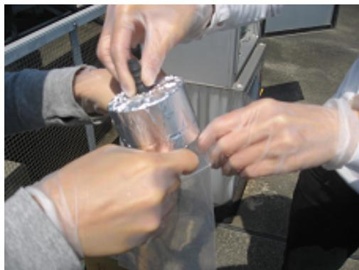
12. キムタオルに水を湿らせてサンプラーの内側及び外側、冷却器のプレート表面などを拭いて掃除する。
