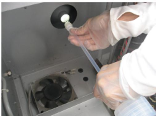
17. サンプルボトル上部のL字テフロンチューブにドレインチューブを接続する。
