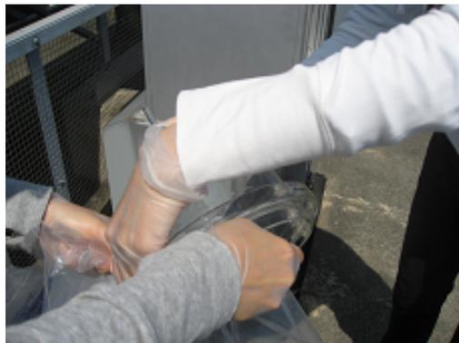
11. 大気採取用フィルターホルダーを回収し、指定のチャック付ポリ袋に入れて、機材収納箱に収納する。
