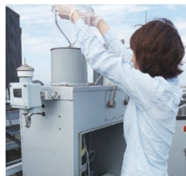
自動採水器を用いた雨中水銀のモニタリング
