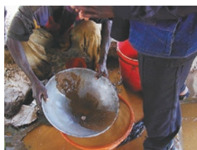
後発開発途上国における小規模金掘鉱山での水銀を用いた金抽出
